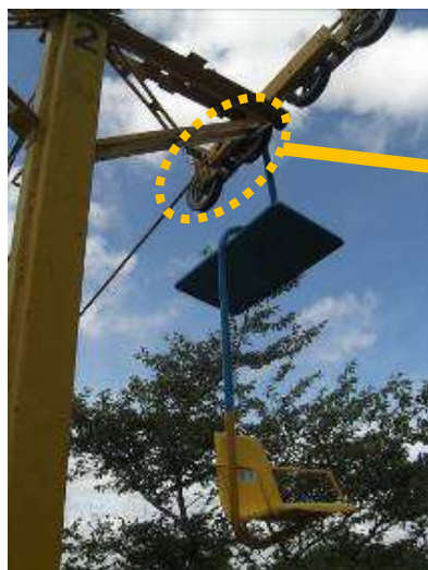
脱索検出装置 上記、赤色破線部分の鉄線が索条（ワイヤーロープ）外れを検出し、自動的にリフトの運転を停止させます。
