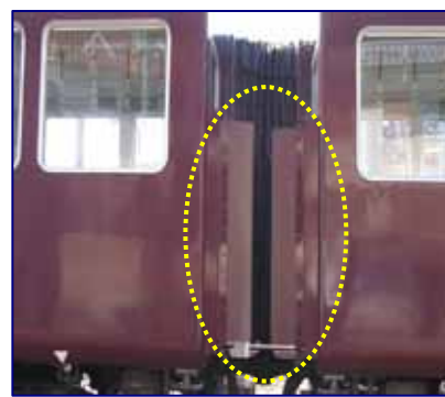
連結面間の転落防護柵
