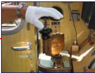
運転士がデッドマンを離した状態(非常ブレーキ作動)
