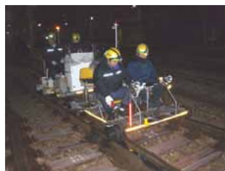
超音波レール探傷器（カート式）による検査
