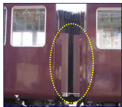
連結面間の転落防護柵
