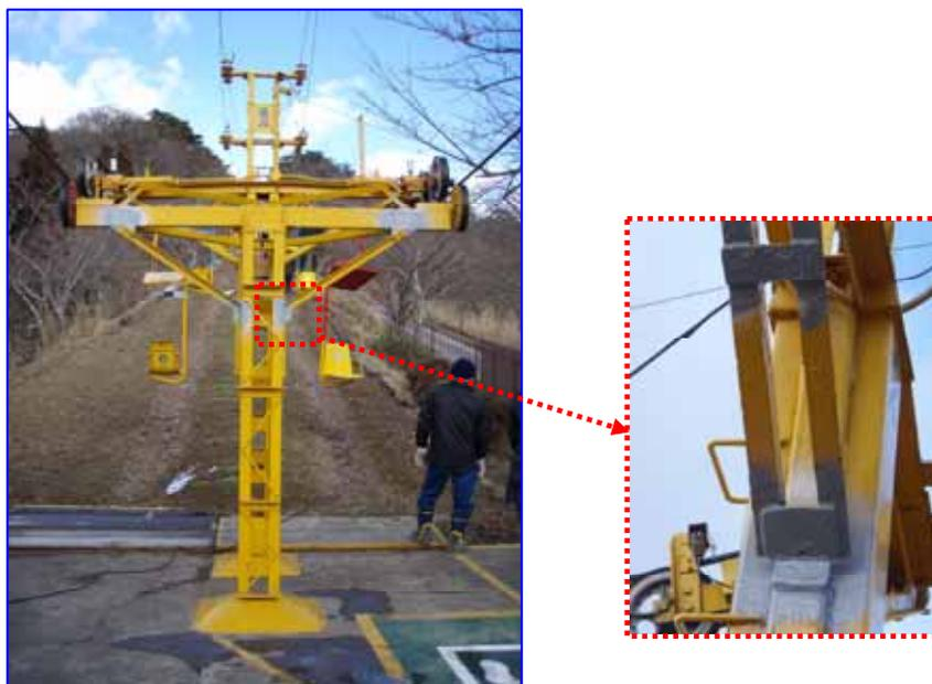
1号支柱の磁粉探傷試験
