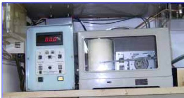
デジタル式風速指示器(左)と雨量計(右)
