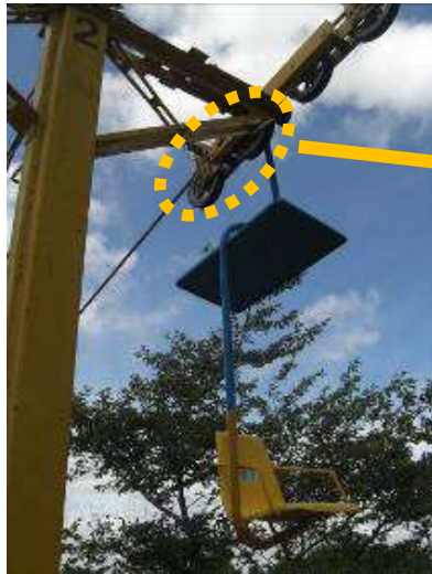
脱索検出装置 上記、黄色破線部分の鉄線が索条（ワイヤーロープ）外れを検出し、自動的にリフトの運転を停止させます。
