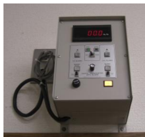
山上駅の雨量監視装置及び 風速監視装置
