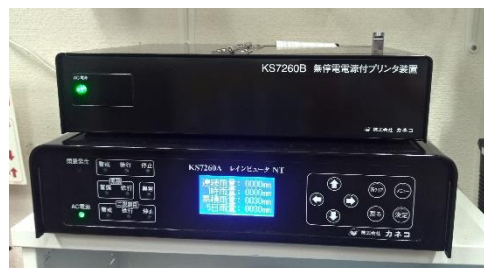
雨量監視装置
