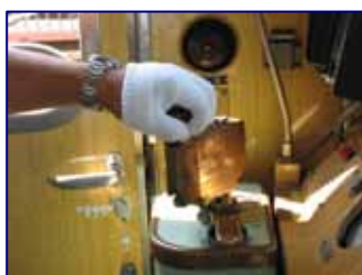
運転士がデッドマンを握っている状態(運転中)
