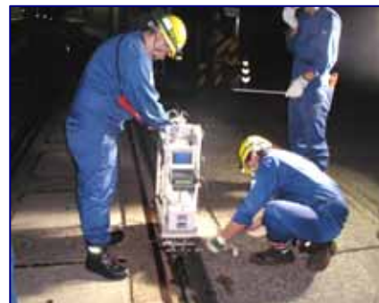
超音波レール探傷器による検査
