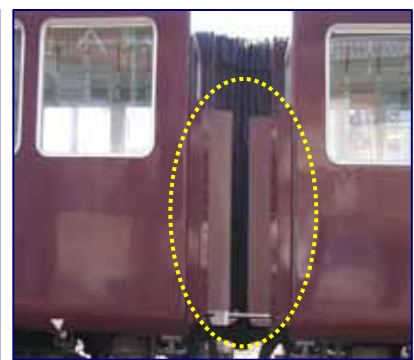
連結面間の転落防護柵
