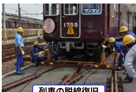
列車の脱線復旧
