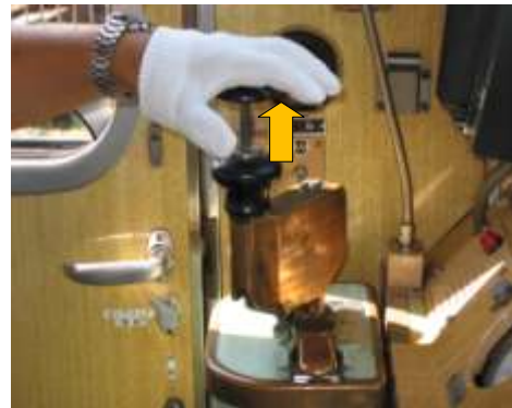
乗務員がデッドマンを離れた状態(非常ブレーキ作動)
