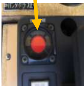
防護無線装置の 押しボタン
