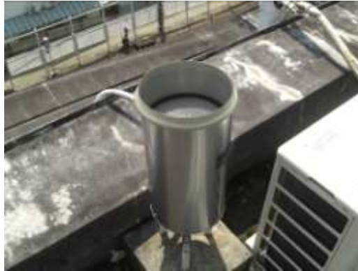
平野駅に設置されている雨量計
