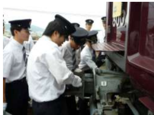
連結器アダプターの取り付け
