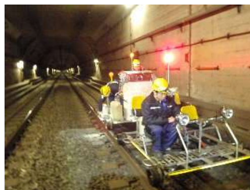
超音波レール探傷器による検査
