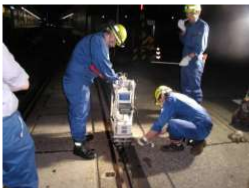
超音波レール探傷器による検査
