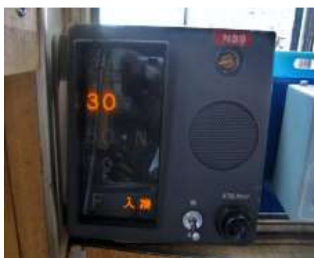
運転台のA T S 表示器 （制御速度等を表示）
