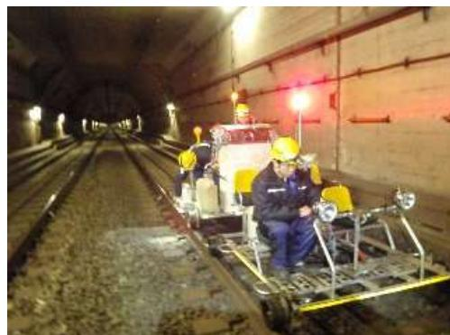
超音波レール探傷器による検査
