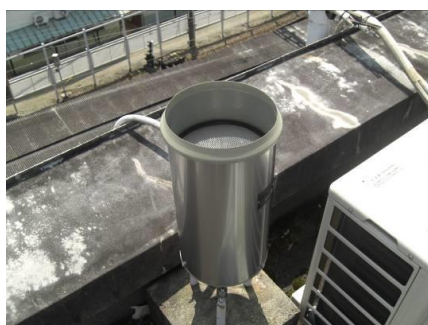
平野駅に設置されている雨量計
