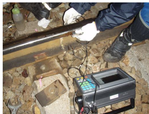
超音波レール探傷器による検査
