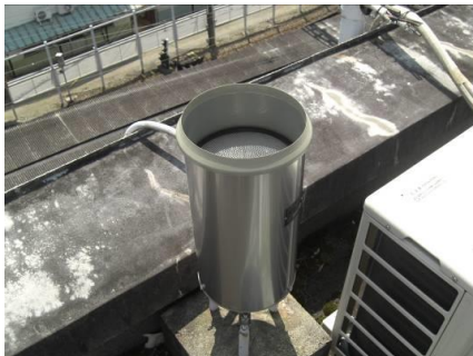
平野駅に設置されている雨量計
