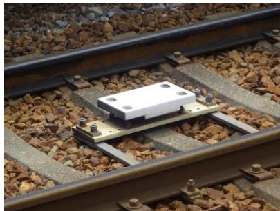
線路上に設置している トランスポンダ
