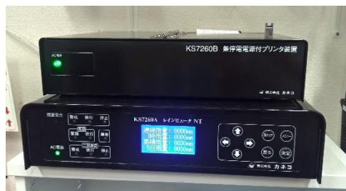
雨量監視装置
