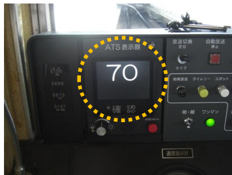
運転台の A T S 表示器 (制御速度等を表示)
