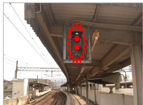
アクシデントサインが動作し、乗務員に知らせる（動作イメージ）
